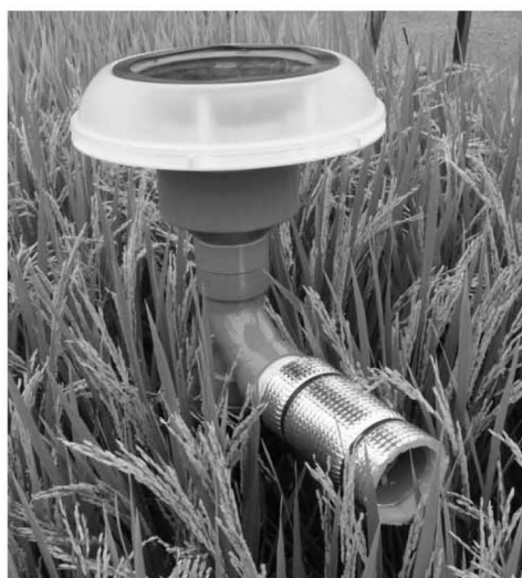
図1：イネ群落に設置したMINCER
