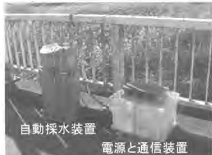
図2 自動採水装置を用いた水質モニタリング (IV-3)
