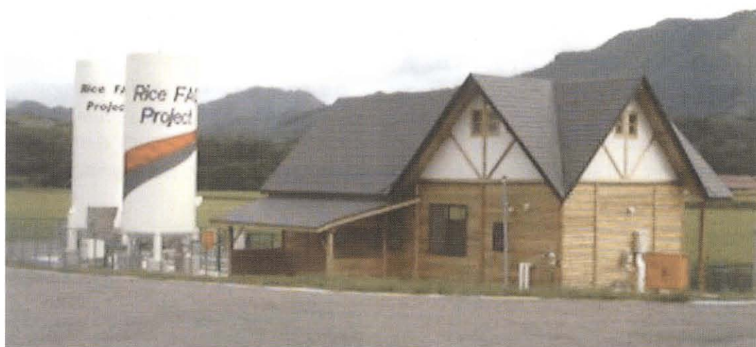
Rice FACE観測・制御室（手前）と液化CO 2 タンク 岩手県雫石町 1997年9月 （詳しくは本文を参照）
