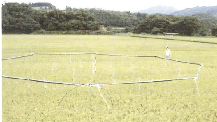
テスト中のRice FACEリング (直径約12m)
