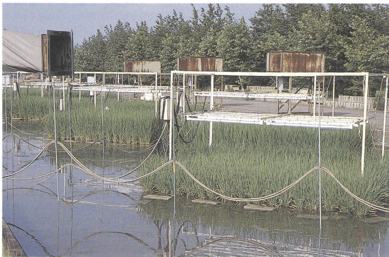
農業環境技術研究所内の水田ほ場に設置した紫外線（UV-B）照射装置
