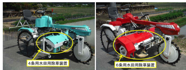
図1 4条用、6条用水田用除草装置
