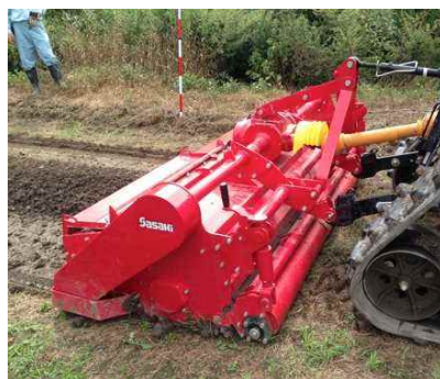
図3 ほ場内表土削除機（開発機）
