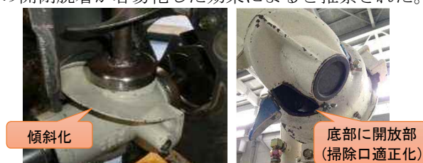
図2 穀粒の残りにくい機内構造の例
