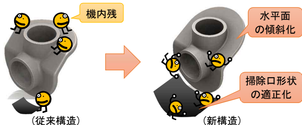
図1 穀粒の残りにくい機内構造のイメージ
