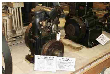
図2 揮発油発動機（1928年頃輸入）（左）とダイセル機関（昭和初期輸入）（右）
