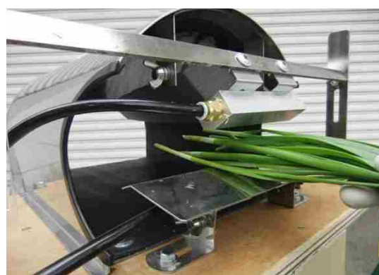
図2 上下ノズル間にニラを挿入した様子
