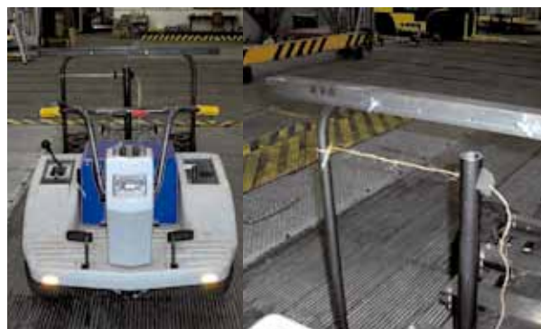
図 2 試作フレームを装着した農用運搬車と変形量測定ジグ
