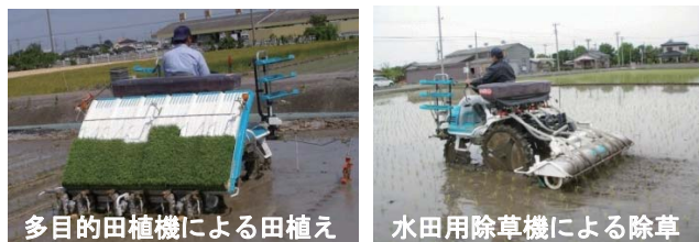
図1 多目的田植機と水田用除草機による米ぬか同時散布田植えと除草
