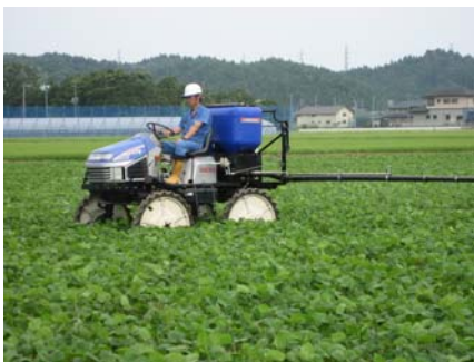
図7 可変施肥機(追肥用) 作業風景
