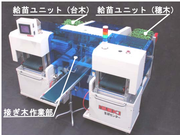
図1 全自動接ぎ木装置の外観
