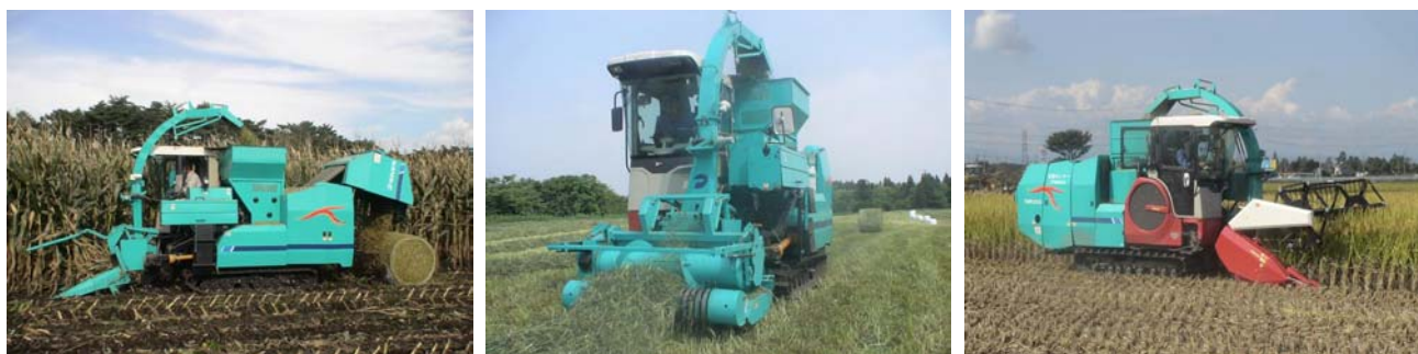
図2 開発機による収穫作業（左から、青刈りトウモロコシ収穫、予乾牧草収穫、飼料イネ収穫）
