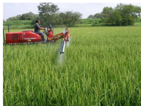
図3 乗用管理機搭載式散布装置による散布
