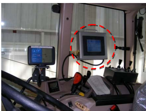
図1 開発した作業履歴情報記録装置
