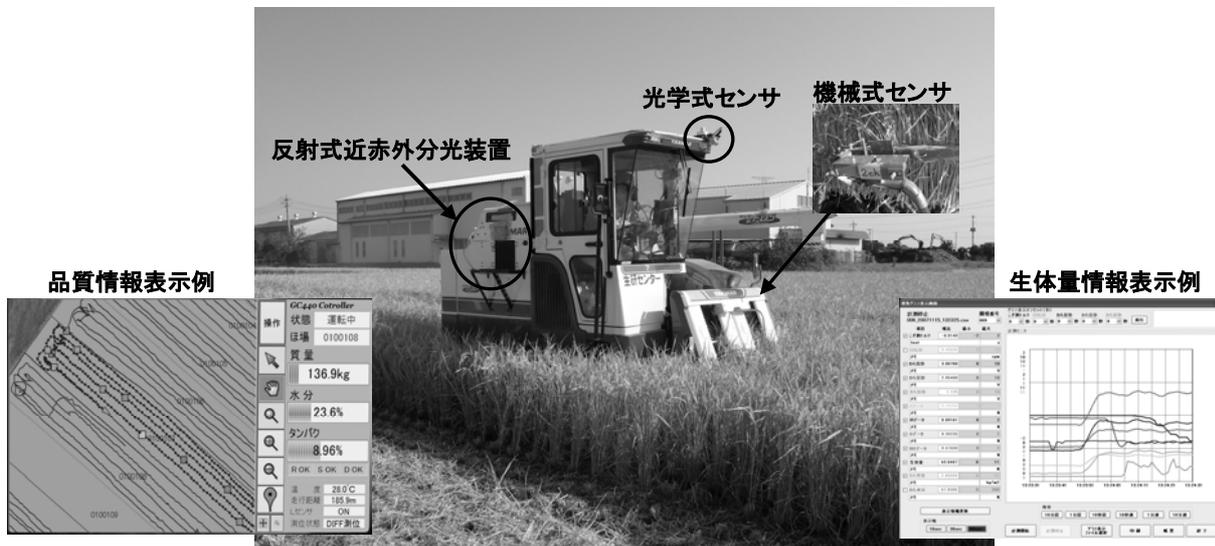
図1 生体情報測定コンバイン
