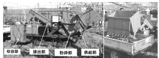
図3 自走投入式せん定枝粉碎搬出機
