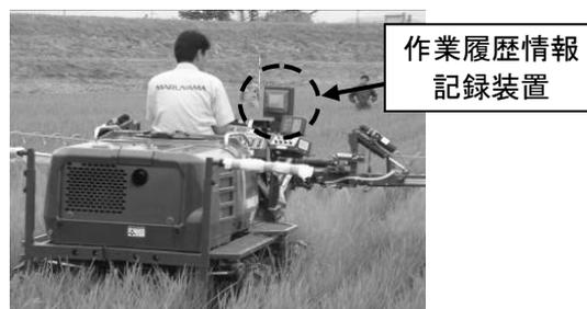
図3 開発した作業履歴情報記録装置
