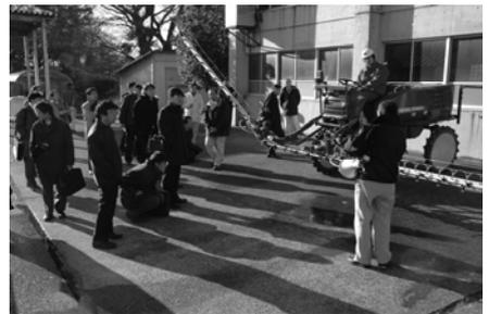
図 6 環境保全型汎用薬液散布装置
