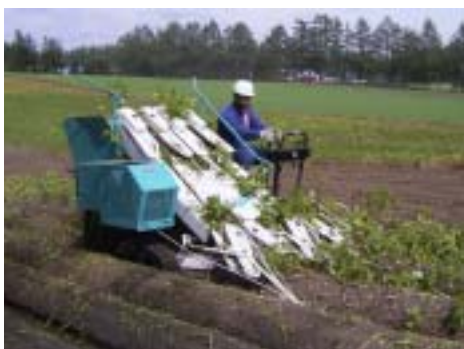
図 引抜き式茎葉処理機(左:自走型、右:トラクター装着型)
