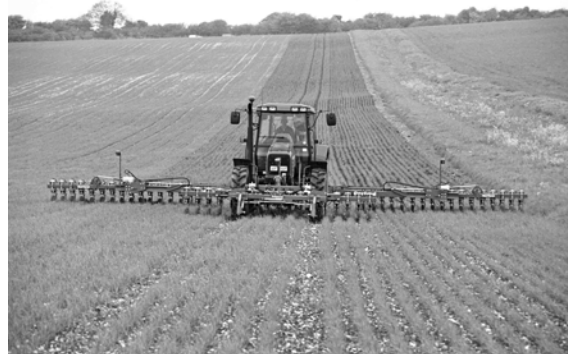
写真2 ビジョンガイダンスシステム付き中耕除草機 (作業幅: 12m)
