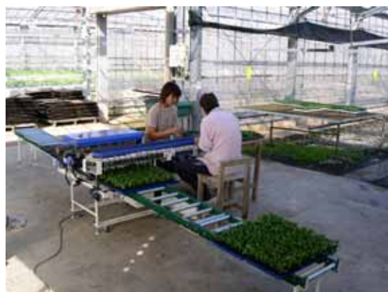
図 1 セルトレイ苗挿し木装置（標準型）
