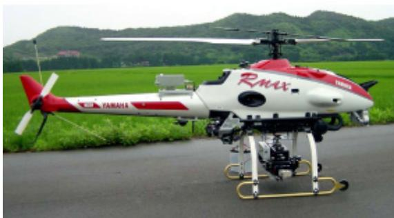
図1 空中測定式作物生育情報測定装置
