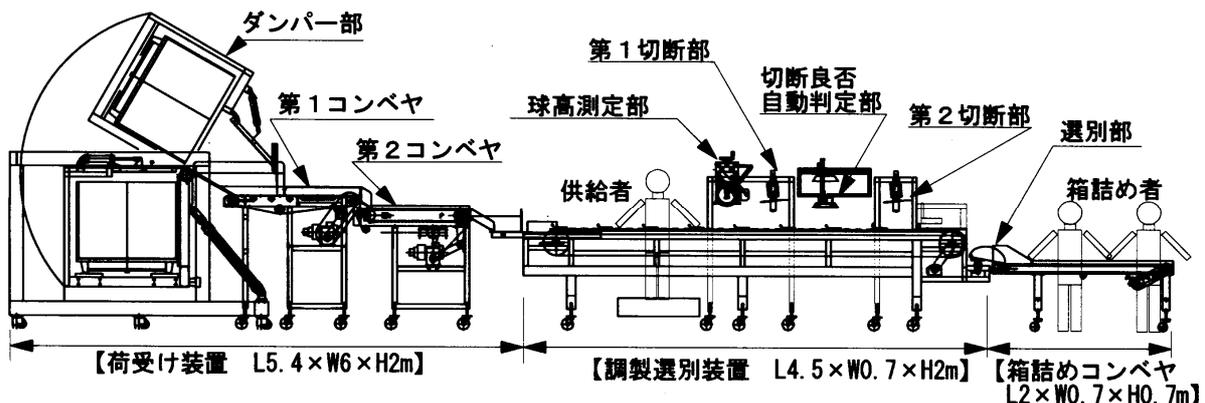
図 1 結球葉菜調製選別装置の概要
