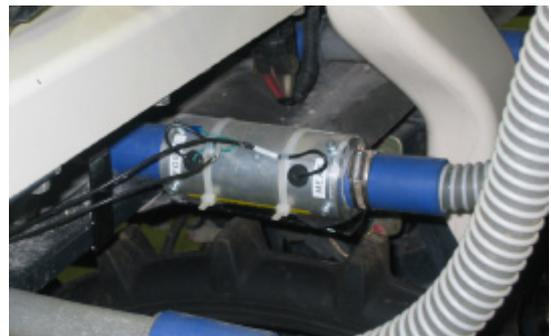
図2 搬送管路に取り付けた測定電極
