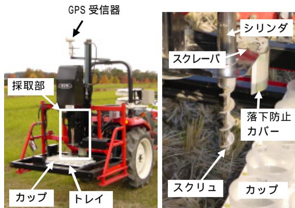
図1 土 壌 採 取 装 置 ( 左 ) と そ の 採 取 部 ( 右 )
