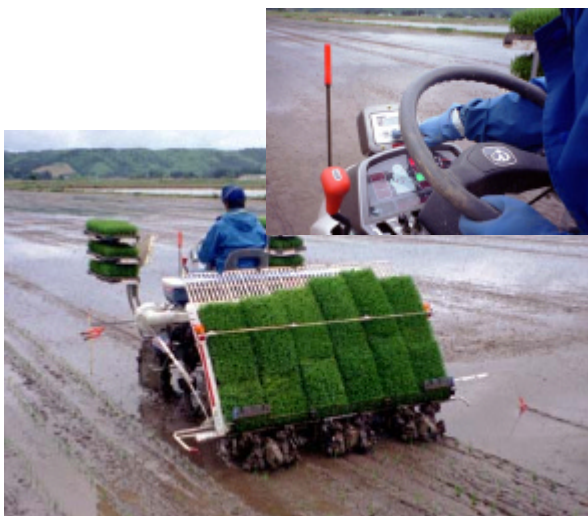
図1 基肥用可変施肥装置による作業
