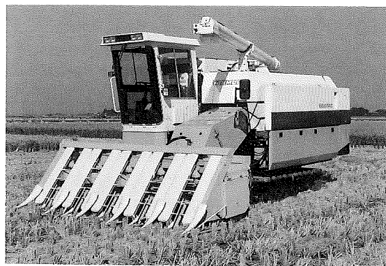
図2 Rヘッダーを装着した大型汎用コンバイン
