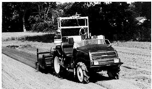
写真1. 試験用車両に搭載した地磁気方位センサによる自律直進走行
