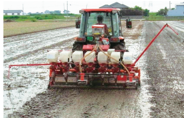
写真3 ショットガン直播機による播種 (佐賀県上峰町)
