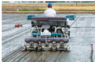
写真2 多目的田植機による播種 (福岡県筑後市)
