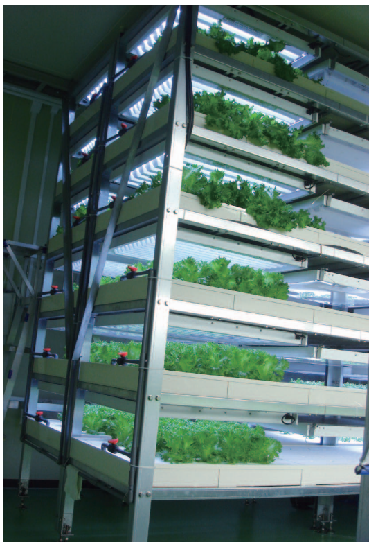
図1 ハイブリッド電極蛍光管(HEFL)光源を用いた栽培システム
