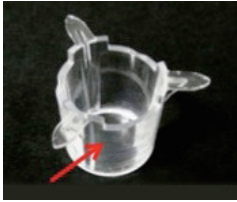
コラーゲンビトリゲル膜チャンバー 矢印の部分にコラーゲンビトリゲル膜が張られている
