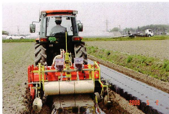
図2 耕耘同時畝立てマルチ播種作業の様子
