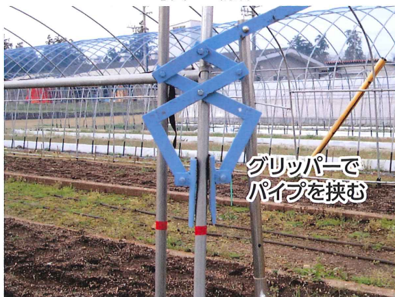
写真2 引き抜き作業前
