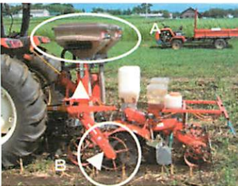
写真1 新たな施肥部を装備した不耕起播種機。 A: 肥料ホッパー。B: 新たに取り付けられた駆動機。 矢印: チェーンボックスの位置(写真2で拡大)
