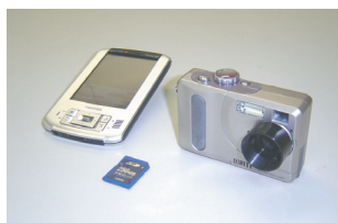
図1 植被率カメラ計測システム (左からPDA、SDメモリカード、植被率カメラ)
