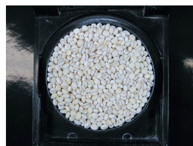
写真1 通常の方法による精麦白度測定材料（約25g）
