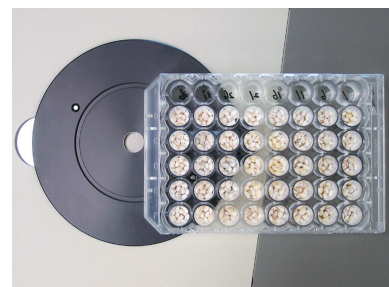
写真2 少量精麦によるハンター白度測定材料（約0.5g） マイクロプレート1穴ごとに異なる材料
