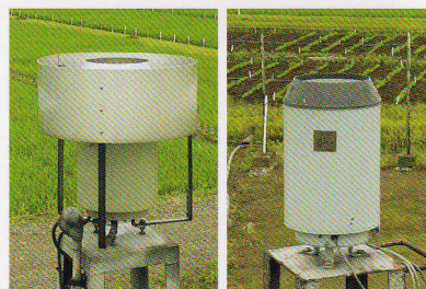
図1 溢水式降水量計（左）と温水式降水量計（右）
