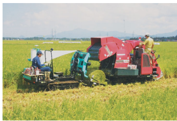
写真1 専用収穫機による飼料イネの収穫作業（右が飼料イネ用ロールベアラ、左が自走式ベールラップ）
