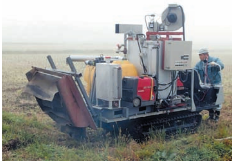
図1 蒸気処理防除機 JJ-5.0
