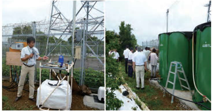
水源の無い園地へのマルドリ方式導入の取り組みを紹介 (左：液肥混入設備、右：貯水タンク)
