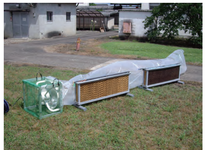
写真2 ファン－ポリダクト－クールパッド連結型の装置（ハウスの中で実際に使用する時は、パッドとパッドの間を5m程度離して設置する）
