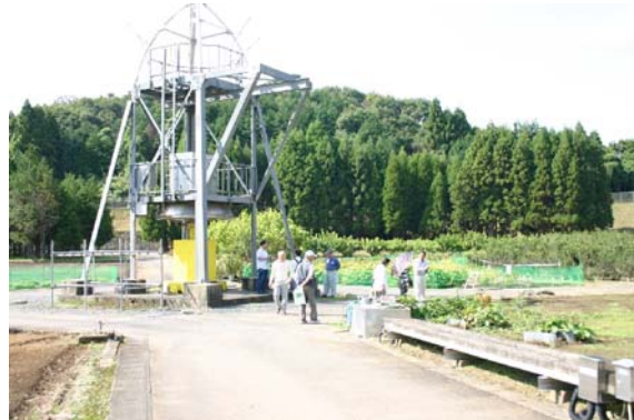
写真2: ガンマーフィールド照射塔。ガンマーフィールドの中央に設置され、88.8TBq(テラベクレル)の 60 Co(コバルト 60)線源を装備しています。
