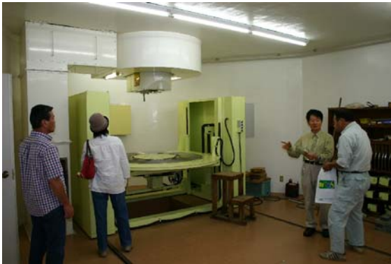
写真1: ガンマールーム。作物の突然変異誘発のための室内急照射用の施設で、種子・球根・穂木などを短時間で照射するために使われます。この施設では、44.4TBq(テラベクレル)の 60 Co(コバルト 60)線源を装備しています。
