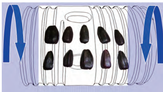
図2 ヒマワリ用播種ロールの仕組み
