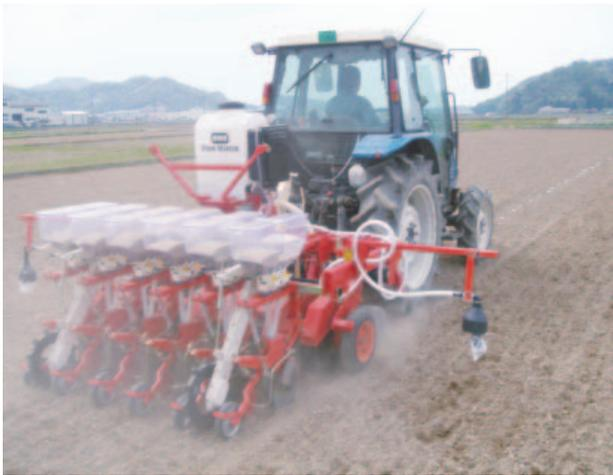
写真1 汎用型不耕起播種機による播種の様子
