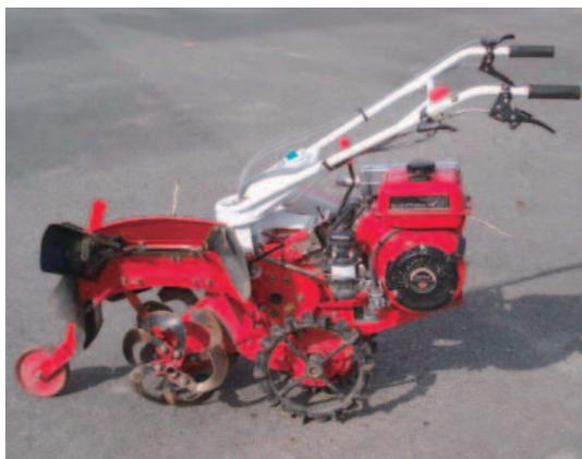
写真1 狭幅作業道造成機
