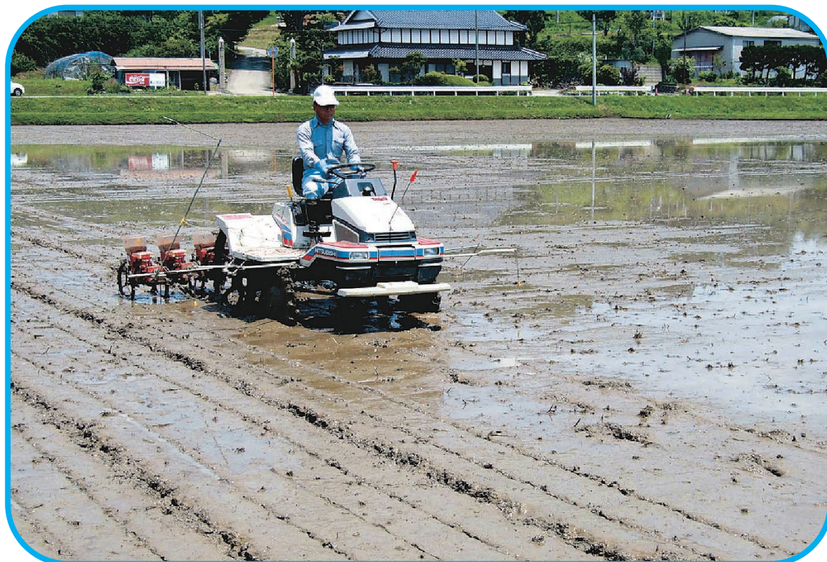
播種機を利用した飼料用稲の鉄コーティング湛水直播（3ページ参照）
