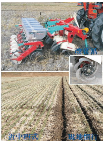
図 麦用に改良した不耕起播種機と 現地試験地における出芽の状況
