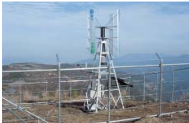
写真3 イチゴのハウス団地を背にしたハイブリッド発電装置
