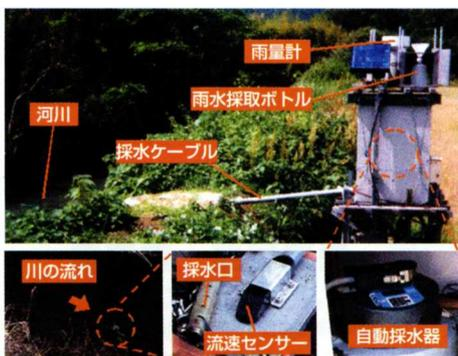
図1 流出負荷自動計測システムの概要
