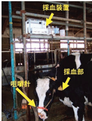
図1 / ウシへの採血装置と咀嚼計の装着
