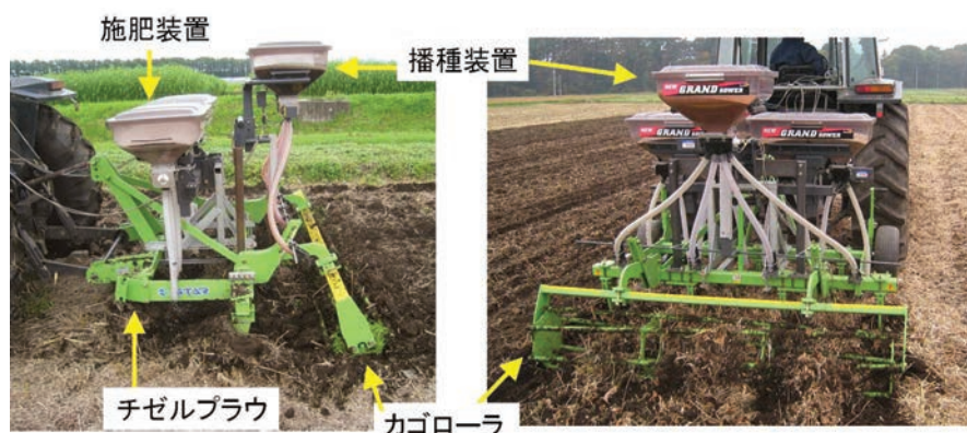
図1／開発した簡易耕同時施肥播種機
