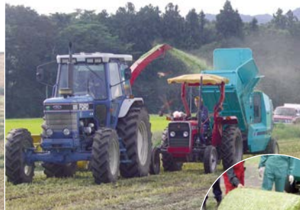
細断型ロールベアラによる飼料稲の収穫調製試験
