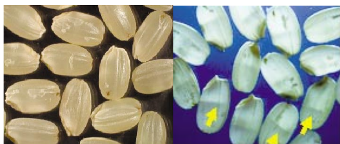
玄米の胴割れ 一見整粒にみえても（左）、光を当てると玄米内部に割れを生じている（右）。
