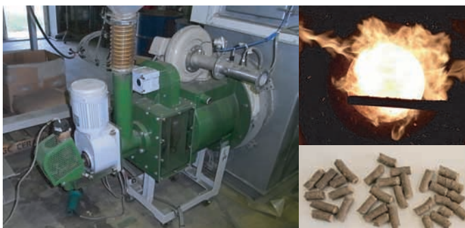
写真 ロータリーキルン式バーナー (左:本体、右上:燃焼状況、右下:稲わらペレット)
