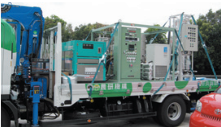
図3 運搬中の可搬型製造装置 発電機(一番左)を用いることで外部からの電力などの供給は不要となる。
