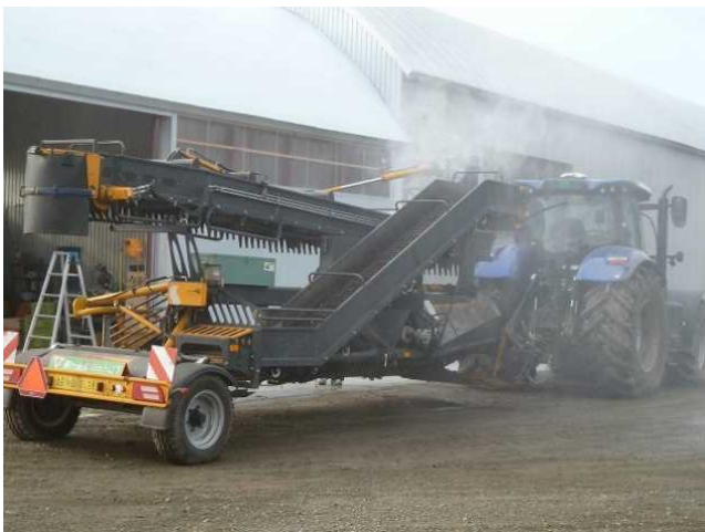
写真6 移動式除土積込機による積込作業と洗浄作業
