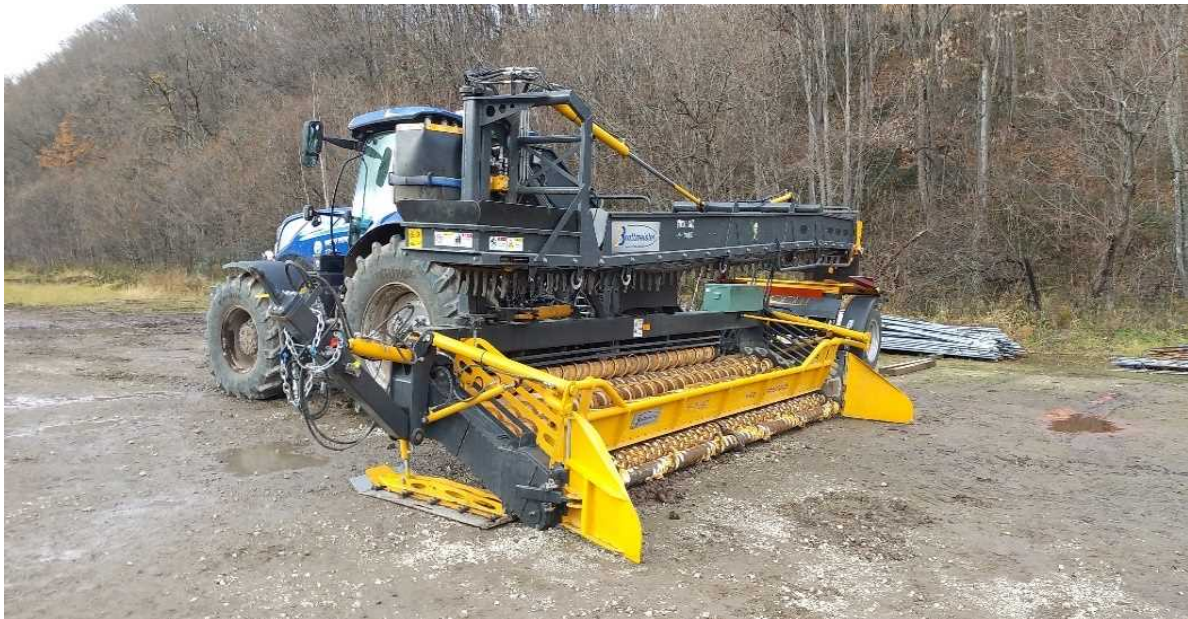
写真1 本試験で用いた移動式除土積込機の全景
