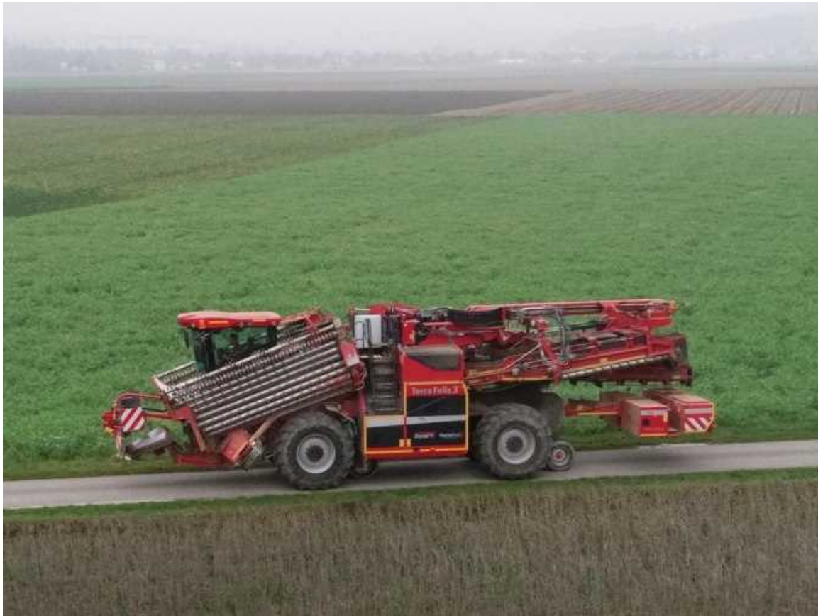
写真 13 自走式除土積込機
