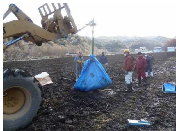
写真 7 土砂重量の計測
