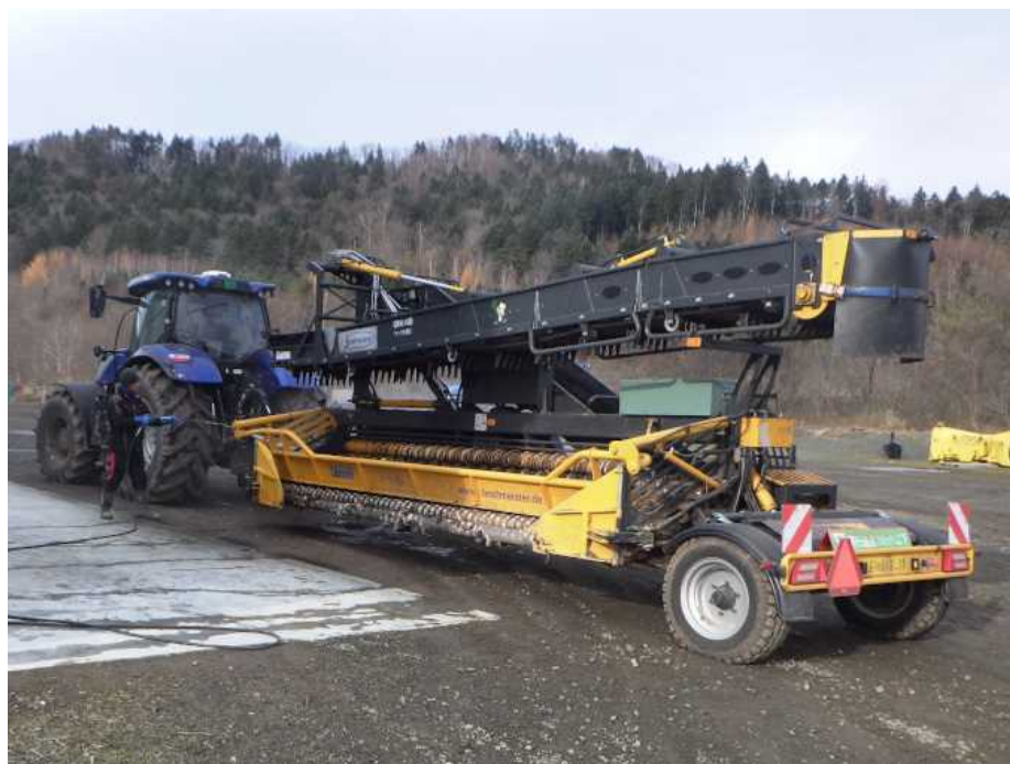
写真 2 道路移動時の移動式除土積込機
