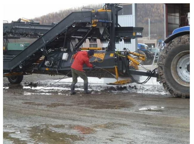
写真6 移動式除土積込機による積込作業と洗浄作業
