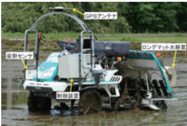
図1 開発した田植えロボット
