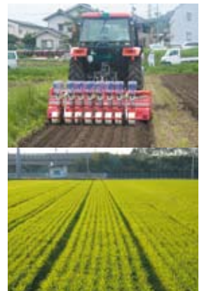
図2 そばの耕うん同時畝立て播種作業機(耕うん幅220cm)と麦の発芽状況
