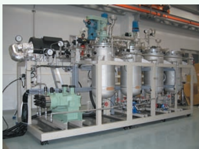
全自動STING-BDF製造装置 (処理量 100L/24h)
