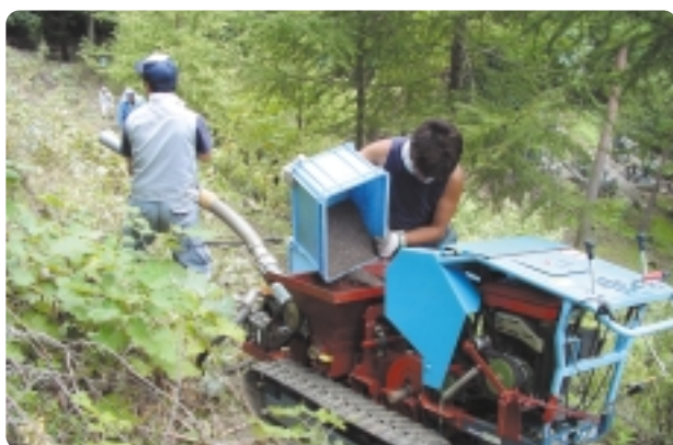
写真2：散布作業システムの移動型散布機。ホッパーに種子だんごの材料を入れて固め、圧縮空気で目的地に散布する。種子だんごは地面に落ちると衝撃で壊れ、牧草が発芽しやすい。
