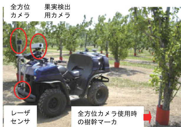
写真. 開発機の概略（果実検出カメラ搭載状態）
