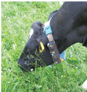
写真1. 牛の首に装着した運動強度計 (市販の携帯電話ケースに入れ、首輪に取り付けている)
