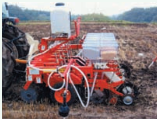
写真2 汎用不耕起播種機(松山INSV600型) 中央農研が試作改良を続けてきた汎用不耕起播種機が松山(株)から市販されている。稲、麦、大豆の不耕起播種が可能。
