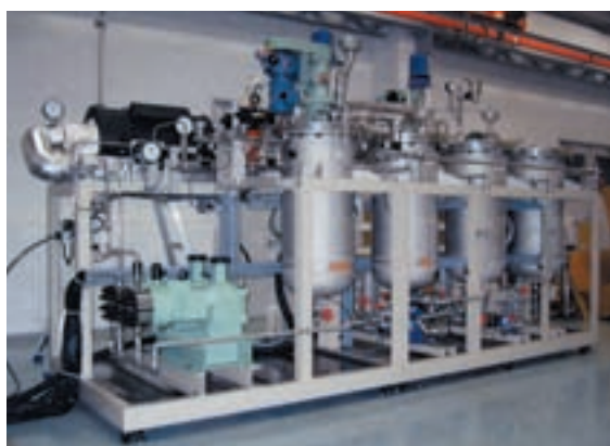
図2 全自動 STING-BDF 製造装置(処理量100L/24h)
